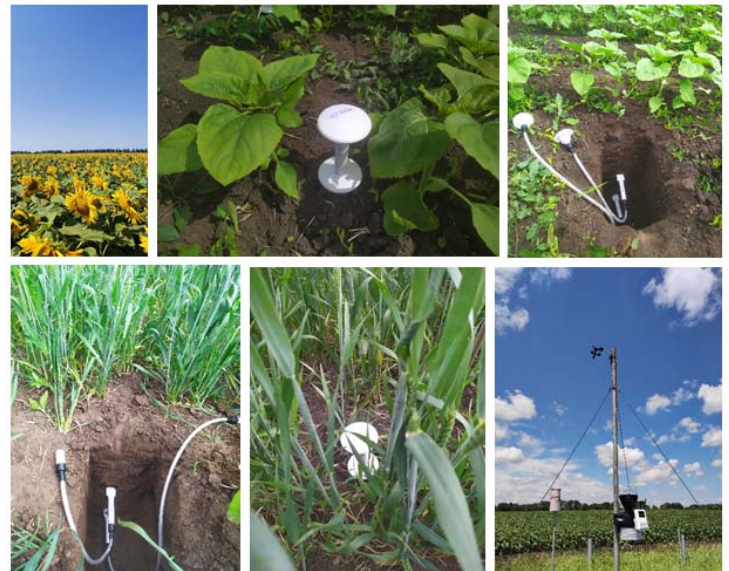
Պատկեր 5. Ուսումնասիրված դաշտերում հողի խոնավության և ջերմաստիճանի հաշվիչների և ավտոմատ եղանակային կայանի տեղադրում (լուսանկարը՝ Սերգեյ Մեդինեց):
