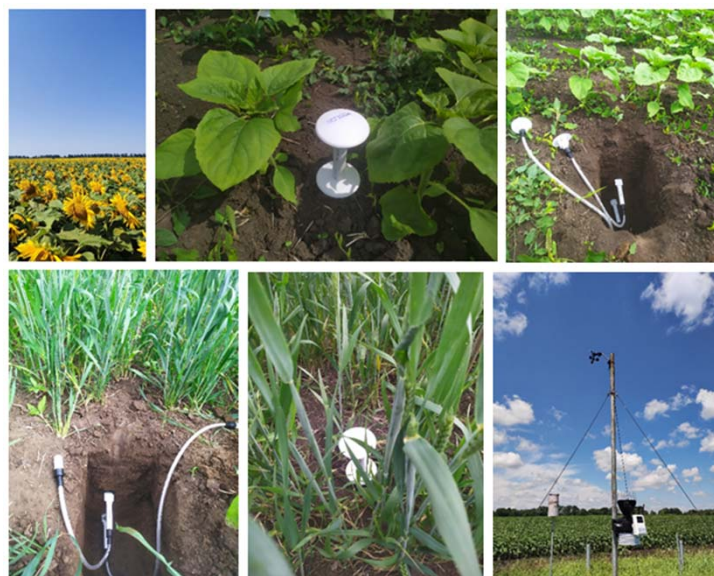
Рис. 5. Встановлення вимірювачів вологості та температури ґрунту і автоматичної метеостанції на досліджуваних полях (фото: Сергій Медінець).
